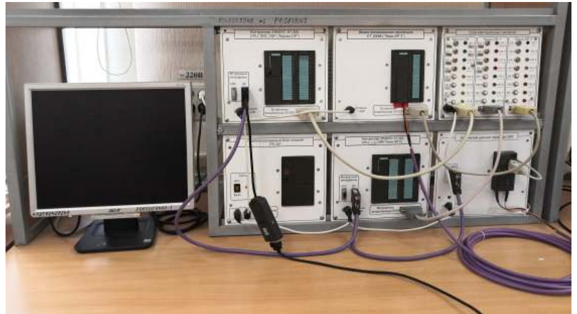
实验台-基于AS-i设备的自动化系统
